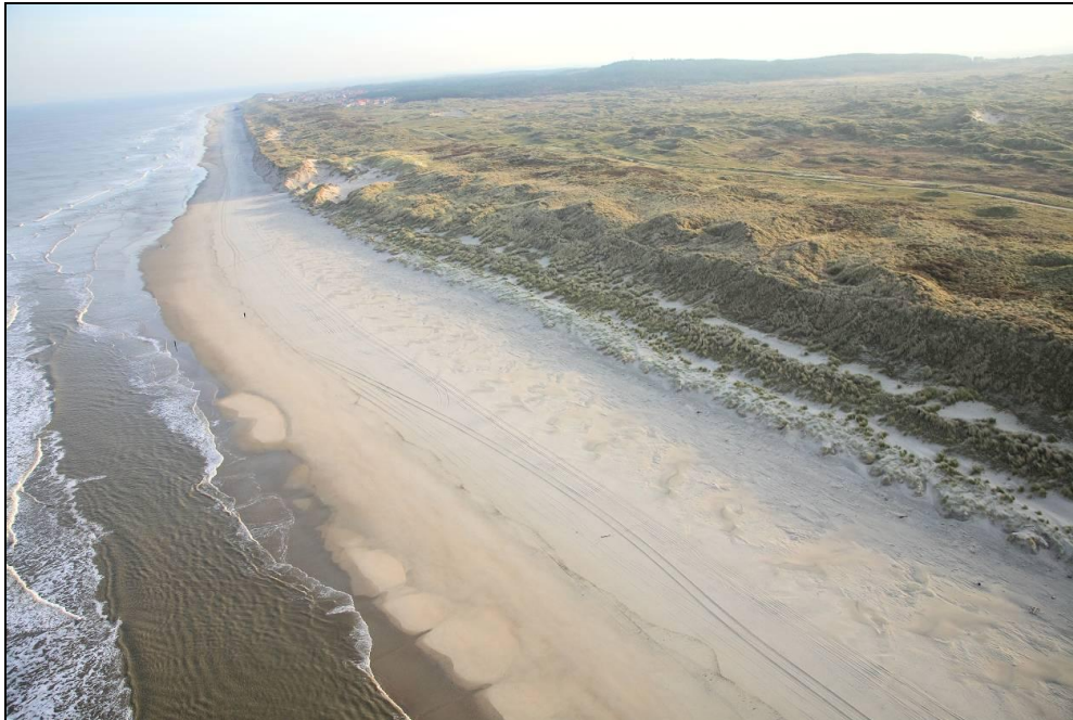
Foto: RWS, J. van Hout Luchtfotografie. Fotonummer 34. Ten westen van de grote kuil bij km 48.90 is de zeereep onbeschadigd, ten oosten (links op de foto) is er een klif ontstaan.
