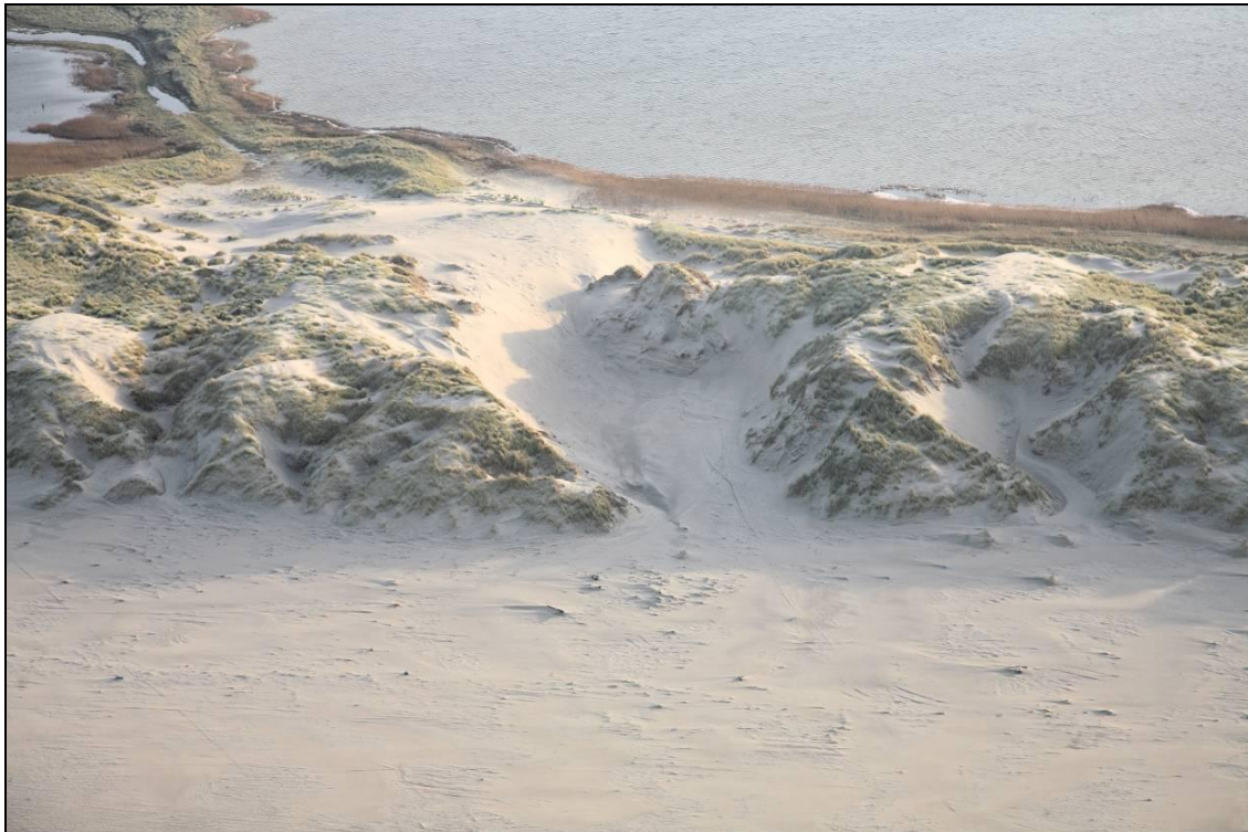
Foto: RWS, J. van Hout Luchtfotografie. Fotonummer 2. Kerf tussen km 1 en 2. Extreme overstuiving is hier vooral het gevolg van een zeer forse aanzanding op het strand.
