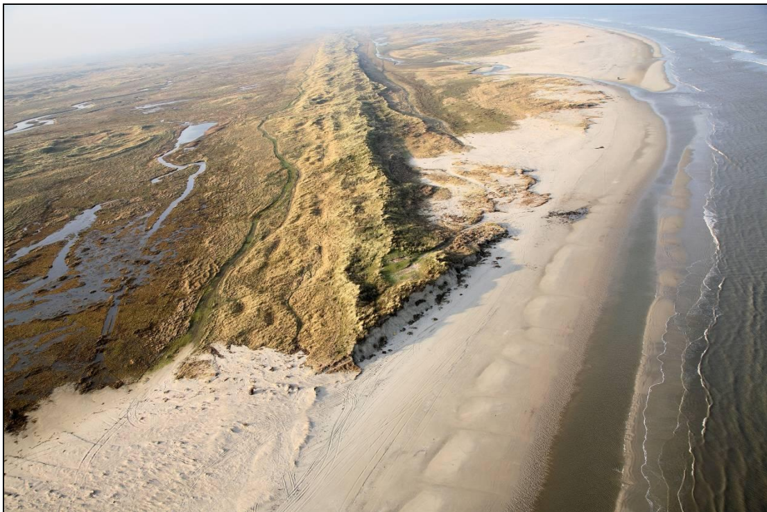
Foto: RWS, J. van Hout Luchtfotografie. Fotonummer 50. Extreme afslag aan de oostpunt. De punt van de afslagdijk is na de storm met ca 75m ingekort. Een deel van het zand is verspoeld en naar achteren verplaatst.
