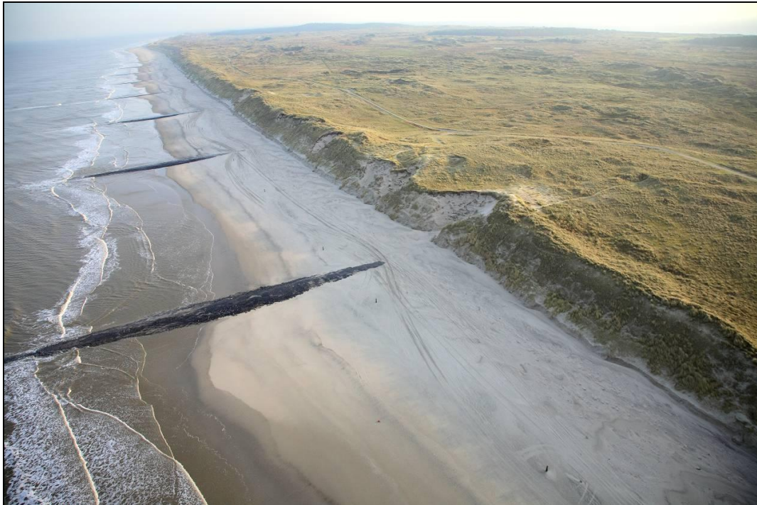
Foto: RWS, J. van Hout Luchtfotografie. Fotonummer 23. Zeereep met stuifkuilen tussen 43.3 en 47.5. Als gevolg van de storm is een klein klif ontstaan.
